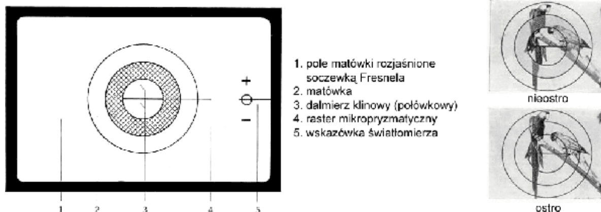
Rys. 8. Pole celownika aparatu Praktica Super TL 1000 [17]
