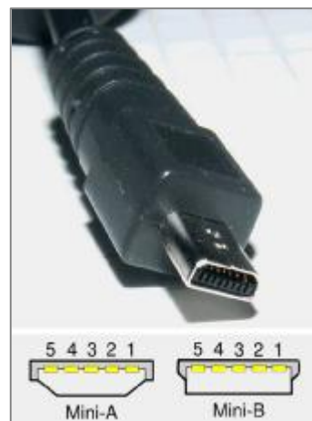
Rys. 5. Wtyczka mini-USB i piny wtyczek mini
