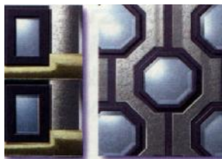
Fot. 3 Ułożenie pikseli w tradycyjnej i nowoczesnej matrycy CCD na podst. [7, s. 9]
