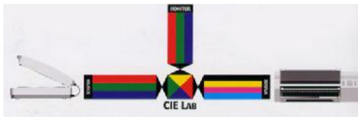
Rys. 33. Schemat urządzeń wejścia i wyjścia z różnymi profilami i przestrzenią odniesienia CIE Lab [9, s. 100]
