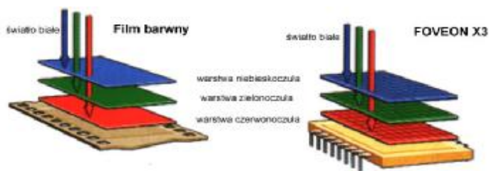
Rys. 11. Przekrój warstwowy matrycy X3 oraz klasycznego materiału fotograficznego barwnego [18]
