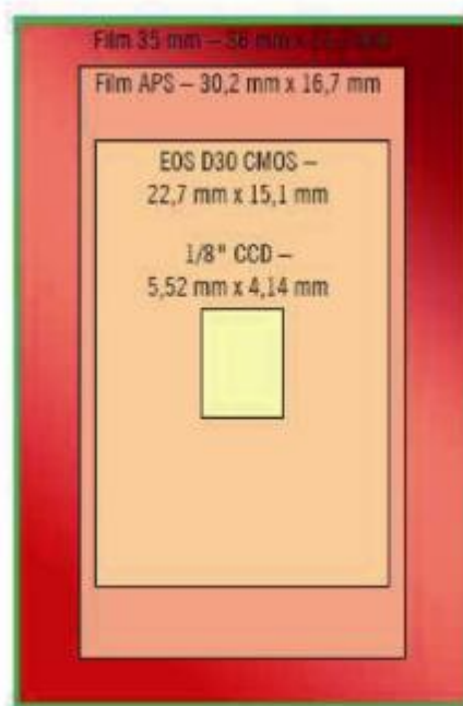
Rys. 5. Porównanie wielkości matryc stosowanych w popularnych aparatach cyfrowych [11, s. 36]
