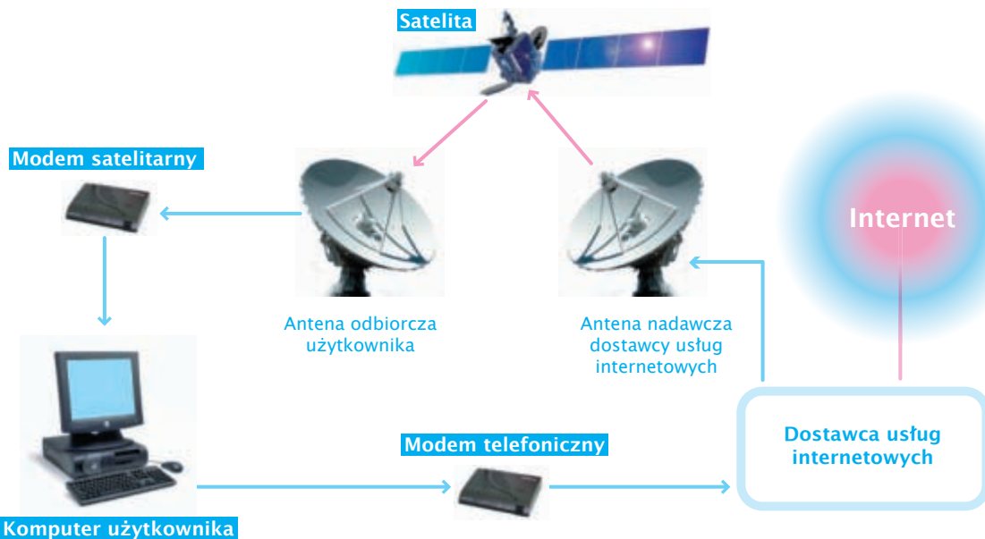
Rysunek 3.8. Przykład połączenia z siecią Internet za pomocą anteny satelitarnej i telefonicznego kanału zwrotnego
