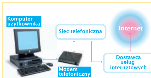
Rysunek 3.6. Przykład podłączenia do sieci Internet za pomocą łączy komutowanych i linii sieci telefonicznej
