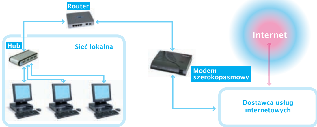
Rysunek 3.7. Przykład podłączenia do Internetu całej sieci lokalnej
