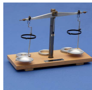
Rys. 2. Waga do równoważenia masy probówek przeznaczonych do wirowania [7]
