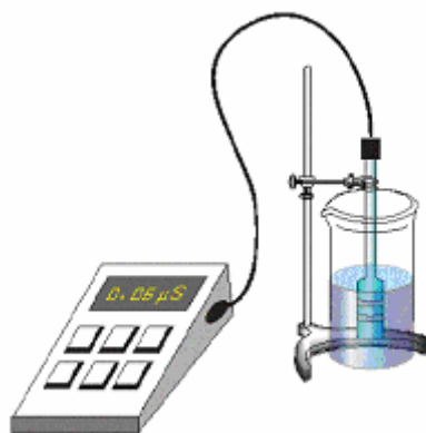
Rys. 6. Zestaw do miareczkowania konduktometrycznego [8]
