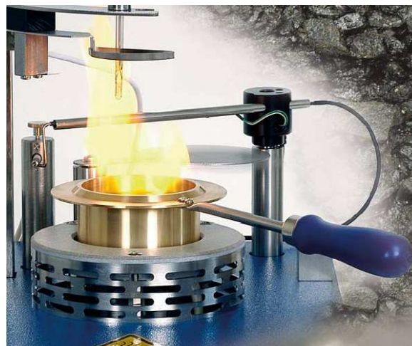
Rys. 13. Pomiar temperatury palenia metodą tygla otwartego Clevelanda [22]
