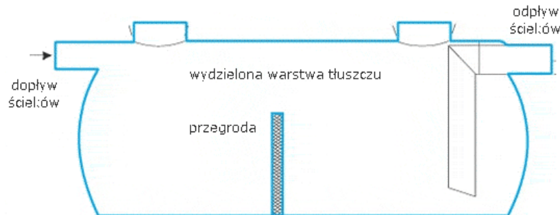
Rys. 10. Schemat separatora tłuszczu [11]
