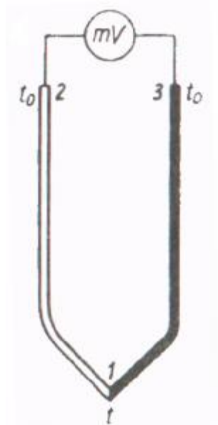
Rys. 11. Obwód termoelektryczny z miliwoltomierzem: 1– gorąca spoina, 2 – zimna spoina [5]
