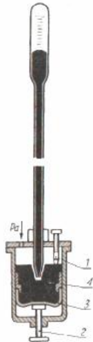
Rys. 21. Barometr Fortina: 1 – śruba, 2 – śruba, 3 – membrana gumowa, 4 – rtęć [1]
