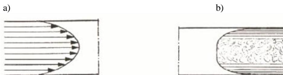
Rys. 28. Rozkład prędkości w przepływie a) laminarnym, b) burzliwym [5]
