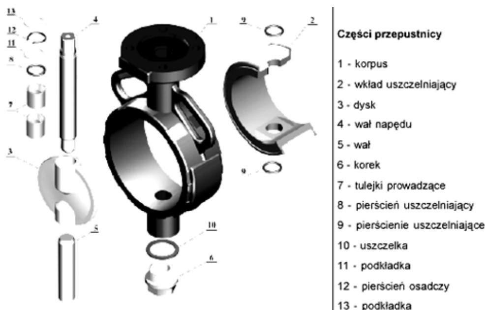
Rys. 11. Budowa przepustnicy szczelnej typu PRS [13]
