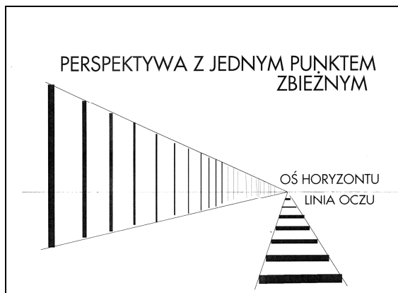
Rys. 4. Schemat rysunkowy perspektywy z jednym punktem zbiegu Źródło: materiały autorskie
