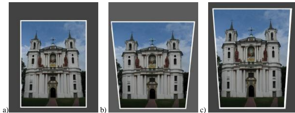
Fot. 29. Komputerowa korekcja perspektywy: a) zdjęcie bez korekty; b) zdjęcie skorygowane nieprawidłowo; c) zdjęcie skorygowane prawidłowo. Źródło: Materiały autorskie.
